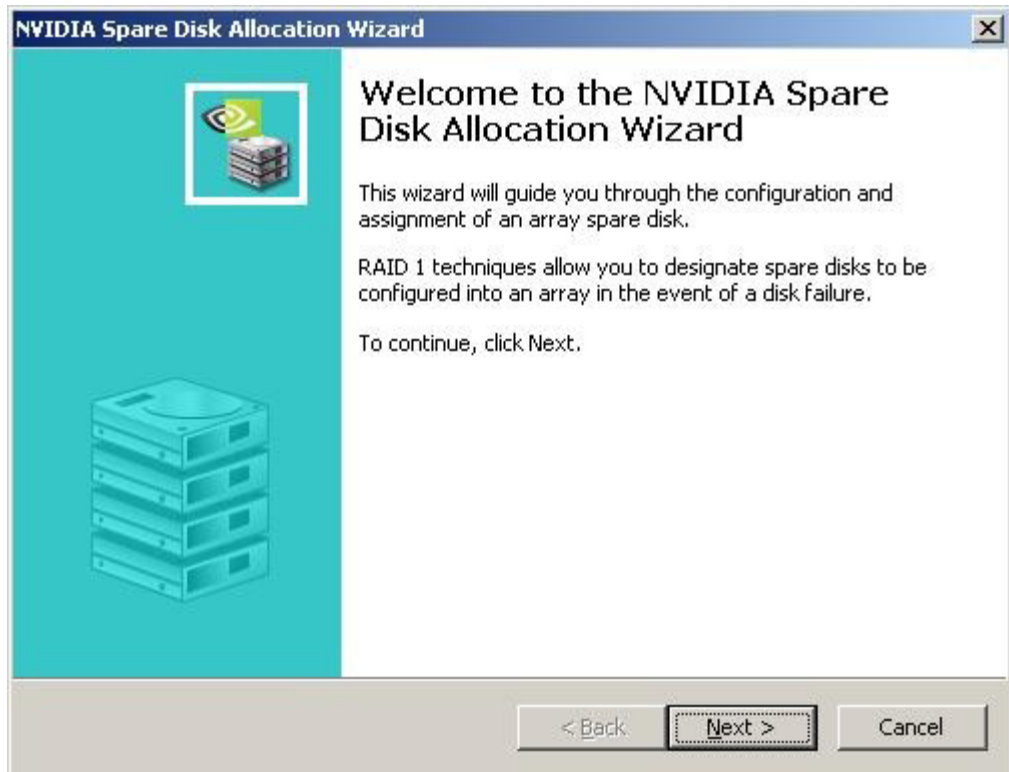
Abb. 4: Die NVIDIA-Oberfläche: Einfache Konfiguration und Verwaltung der Festplattenressourcen (hier am Beispiel Mirroring)
