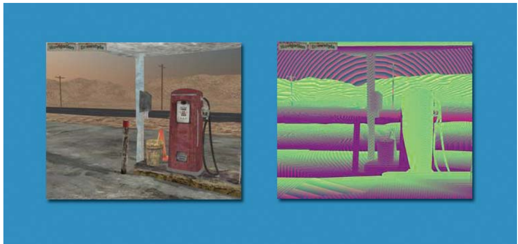
Abb. 5: Farbpuffer (links) und Tiefenpuffer (rechts) der noch nicht ausgeleuchteten Szene
