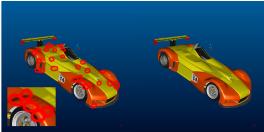
Abbildung 1. Subpixel-Präzision von 4 Bits (links) und 12 Bits bei der NVIDIA Quadro FX (rechts)
