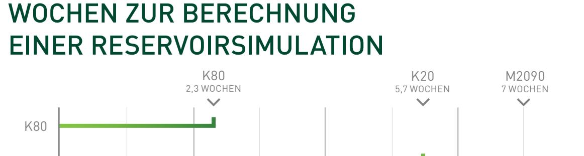
CPU-Server: Dual-Socket E5-2697 v2 mit 2,7 GHz; Grafikprozessor-Server: Dual-Socket E5-2697 v2 mit 2,7 GHz; zwei Tesla K80/M9090; GPU Boost aktiviert
