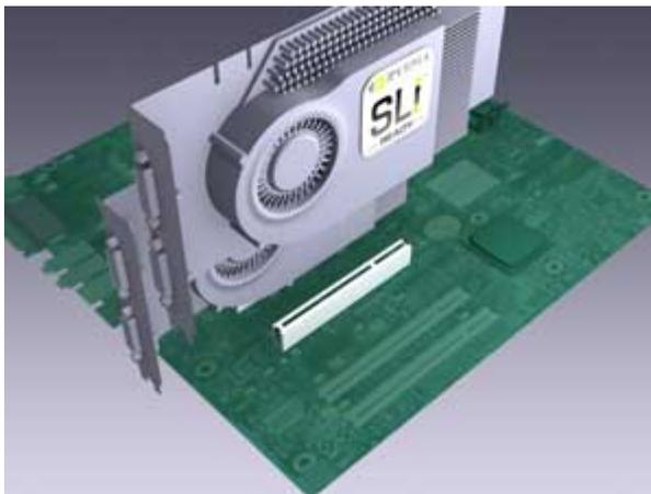
3. Schließen Sie die PCI Express-Zusatzstromkabel an die beiden Grafikkarten an:
